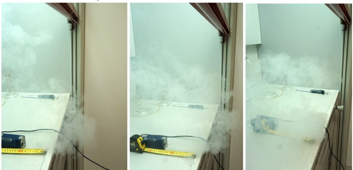
Afbeelding: Rooktesten tijdens werkzaamheden in de zuurkast ZK1 1.323 biochemie waarbij de rook in de raamopening van de zuurkast werd ingeblazen op 3 verschillende afstanden tot de raamopening (linker foto 10 cm, middelste foto 15 cm en rechterfoto 20 cm).
